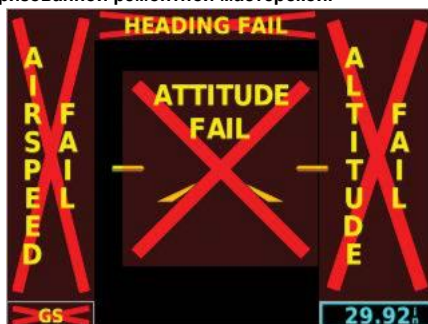
Рисунок 1-2 G5 PFD Предупреждения об отказе
