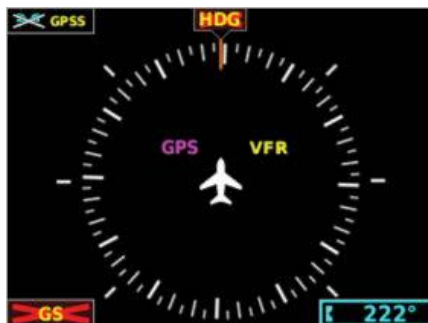
Рисунок 1-3 G5 HSI Предупреждения об отказе
