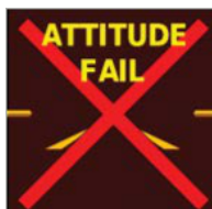
Рисунок 1-6 Авиагоризонт Отказ
