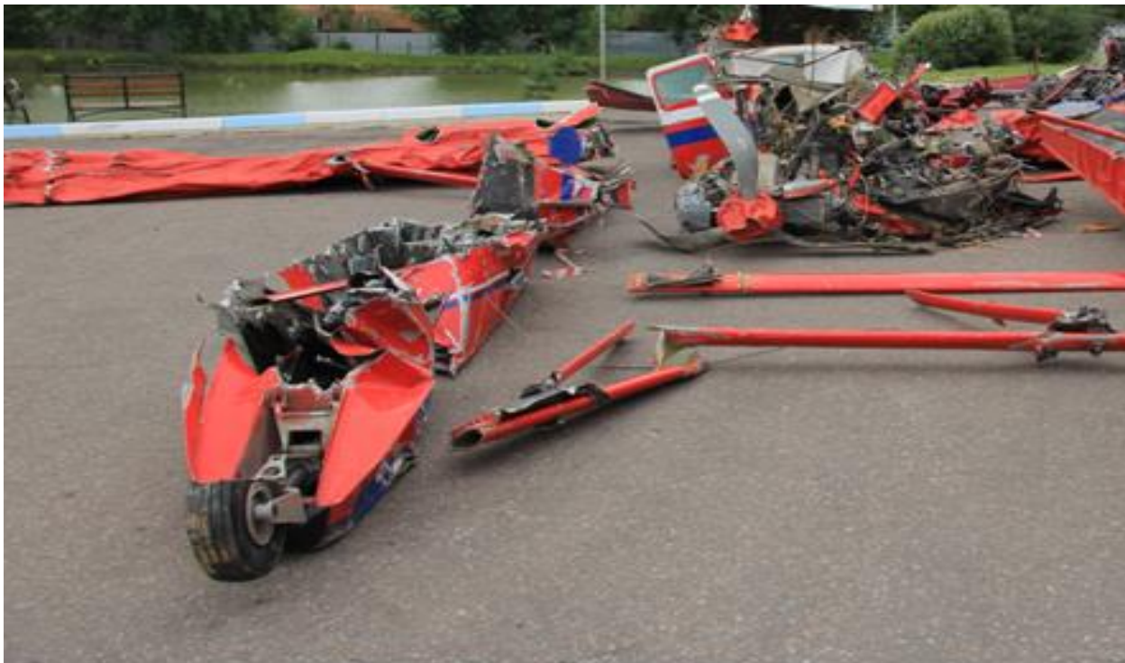
Рис. 8. Правый поплавок со срезанной верхней частью.
