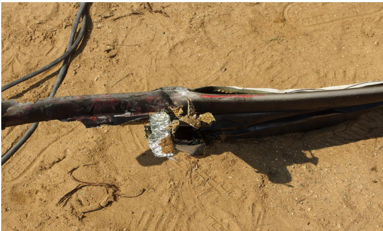
Рис. 9. Фрагмент лопасти несущего винта со следами лакокрасочного покрытия гидросамолѐта
