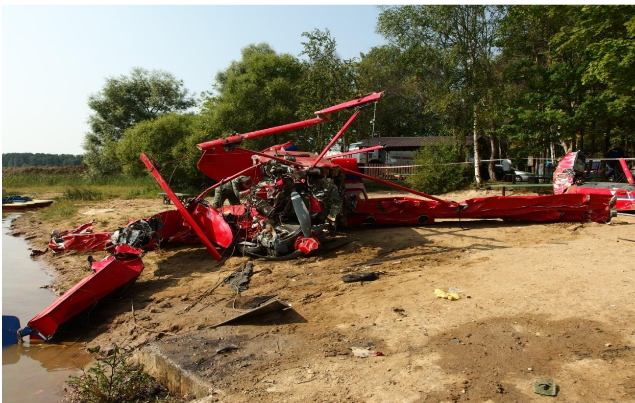
Рис 5. Фрагменты гидросамолёта Cessna U206F RA-67523 после извлечения из воды.
