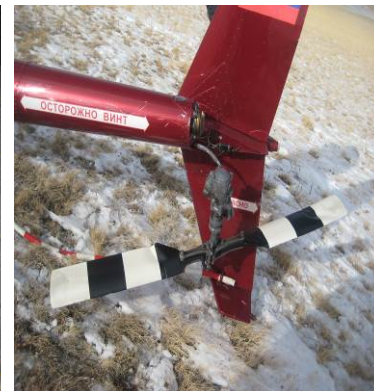
Обрыв болтов крепления хвостового редуктора
