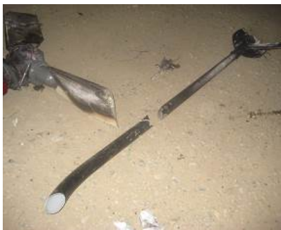
Разрушение правого ползка шасси
