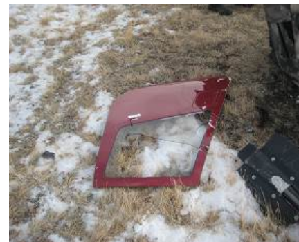
Обрыв левой задней двери с замками в закрытом положении
