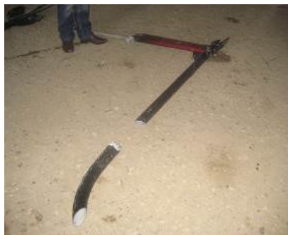
Разрушение левого ползка шасси
