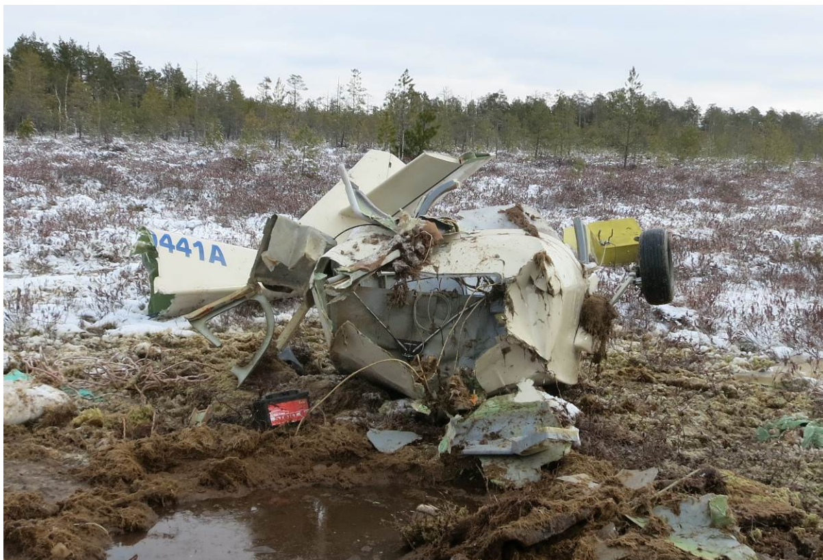
Рис. 10. Место АП. Внешний вид фюзеляжа ВС после демонтажа крыла с СУ и подъёма самолёта из болота. Фото 15.10.2015 г.
