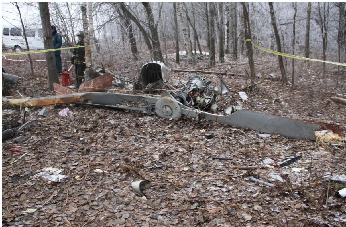
Рис.4. Элементы несущей системы вертолета
