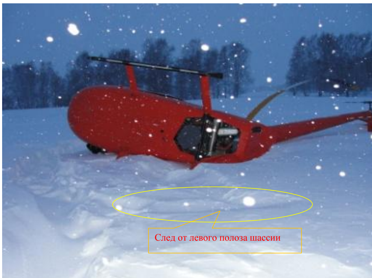
Рис. 8. След от левого полоза лыжного шасси
