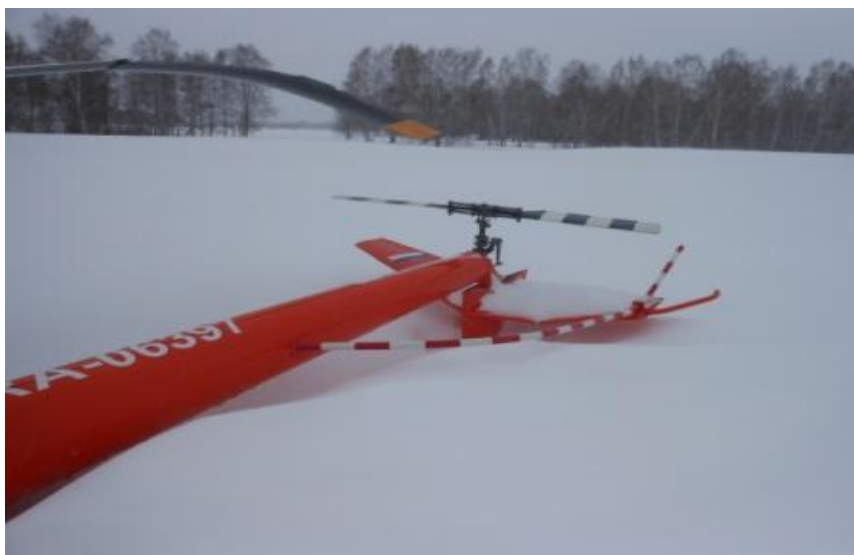
Рис. 7. Состояние рулевого винта, сигнализатора опасной зоны, хвостовой пяты на месте АП
