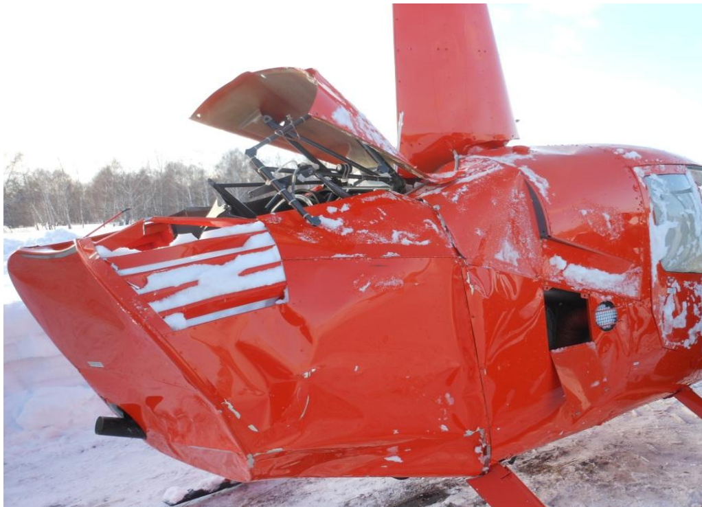
Рис. 3. Состояние фюзеляжа на месте АП
