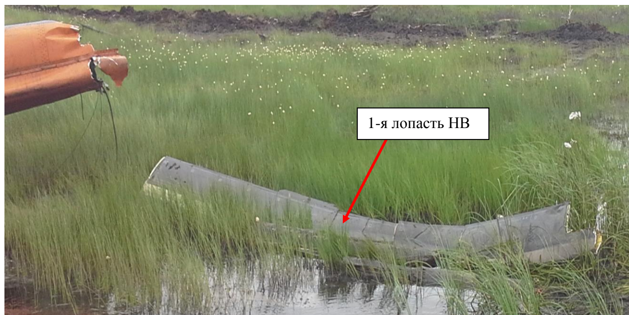
Рис. 10. Положение первой лопасти НВ на месте АП
