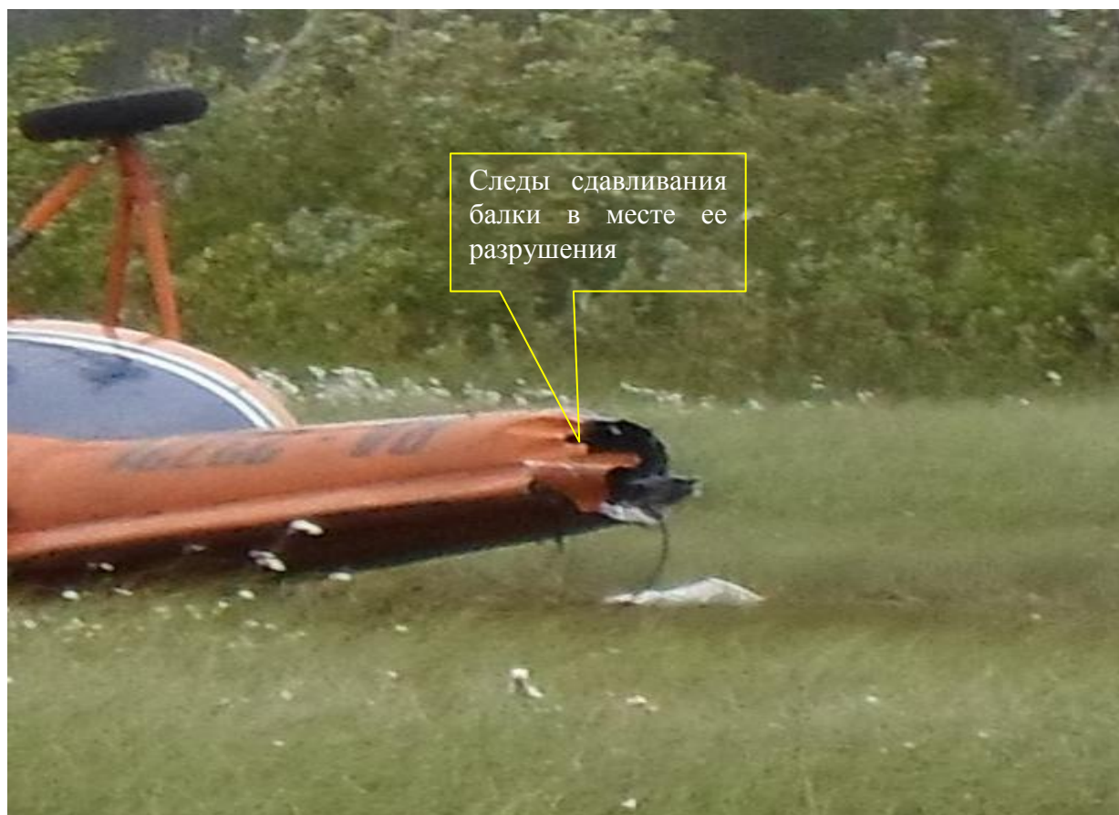
Рис. 8. Место разрушения хвостовой балки
