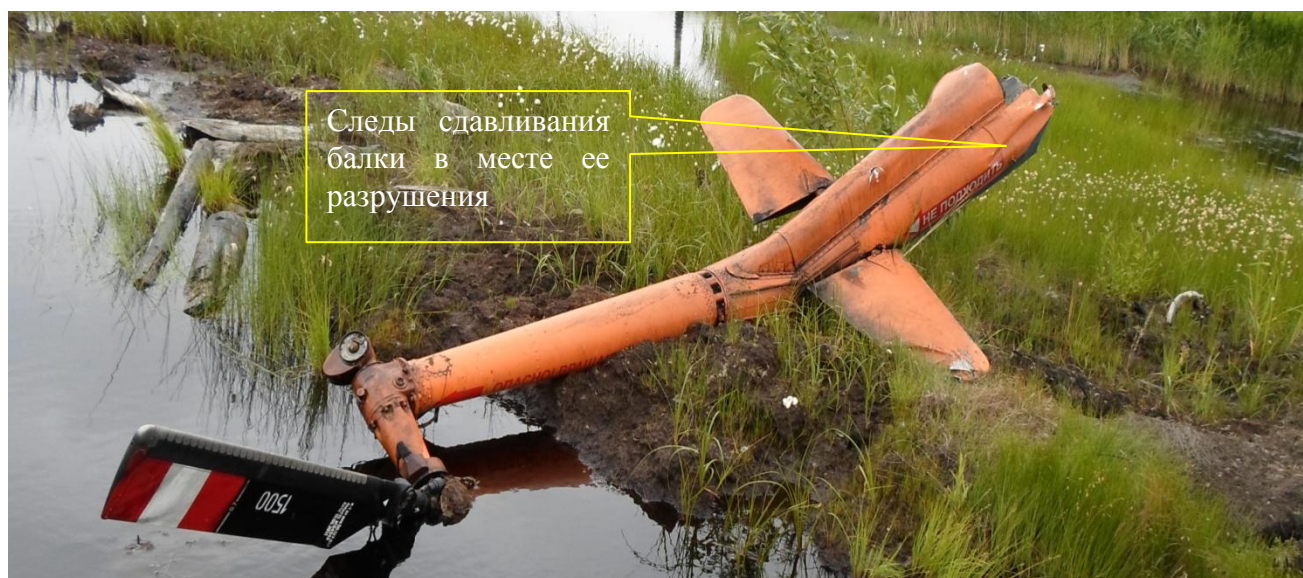
Рис. 7. Фрагмент хвостовой балки
