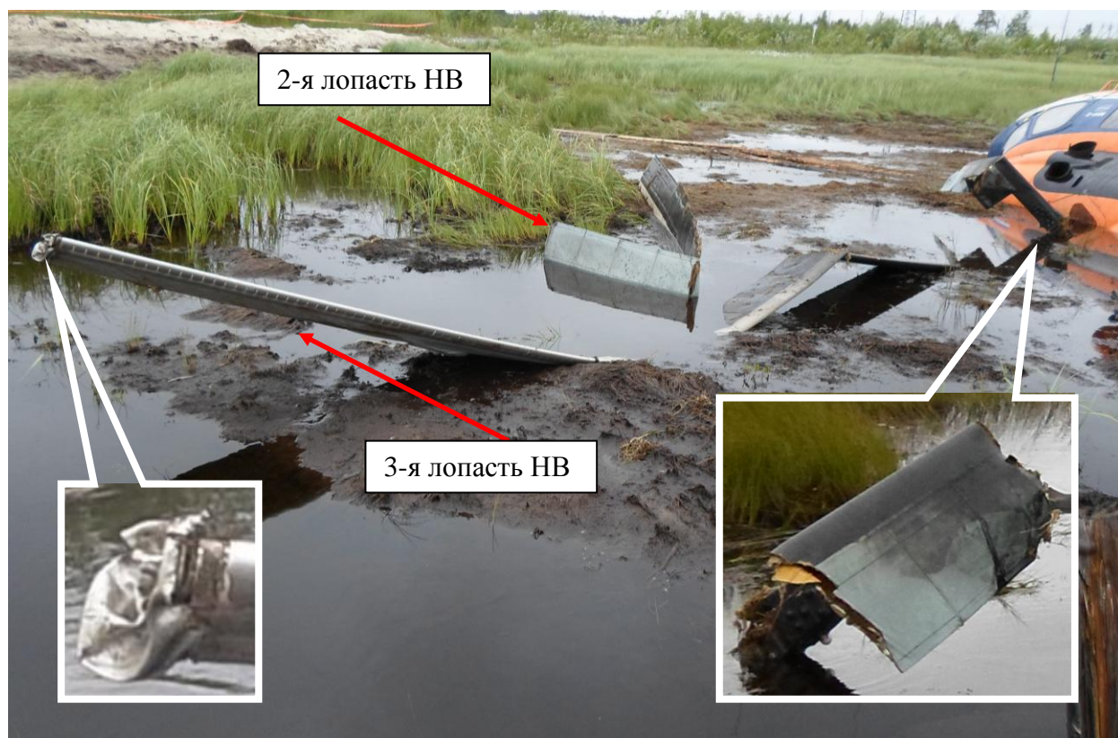
Рис. 11. Положение второй и третьей лопасти НВ на месте АП
