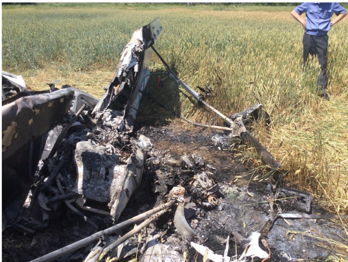
Рис. № 2. Кабина самолёта, двигатель и основные опоры шасси.
