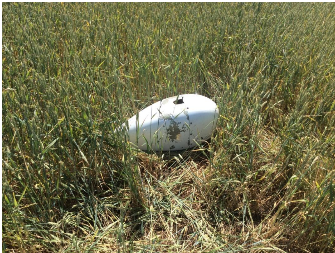
Рис. № 8. Обтекатель переднего колеса.
