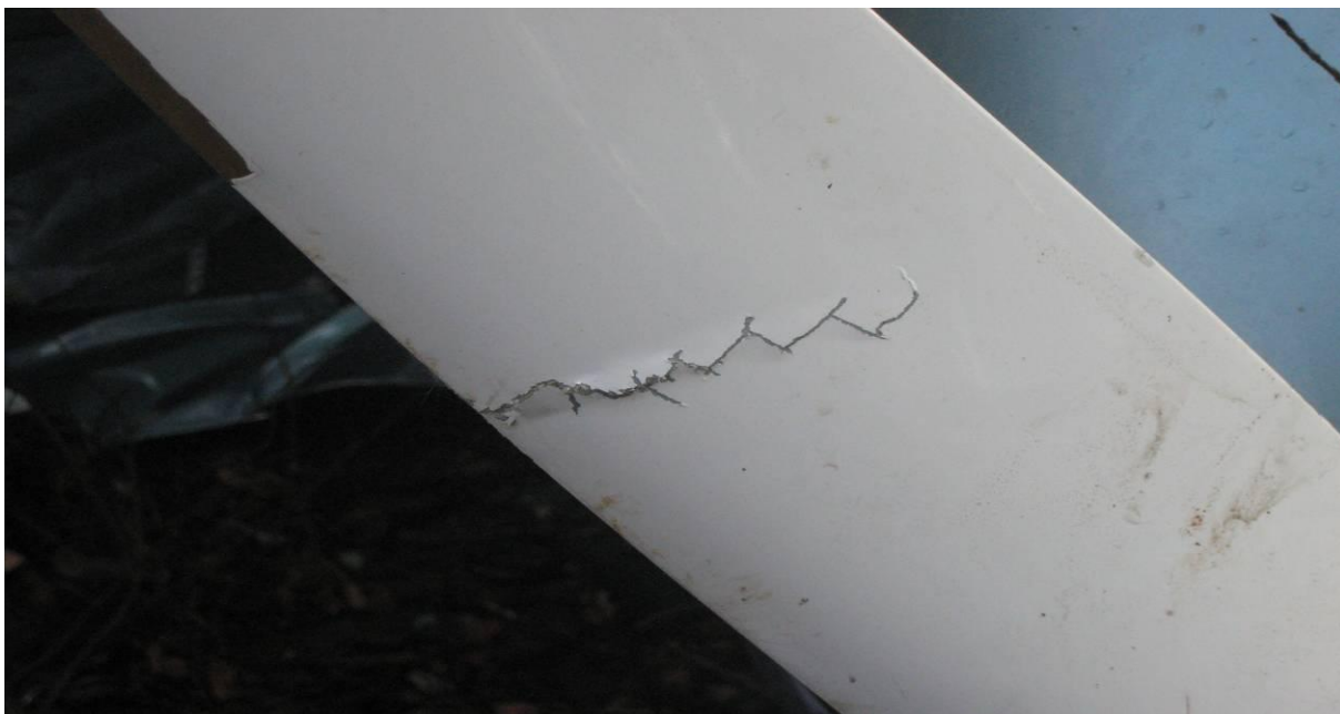
Рис. 14. Вид поврежденной лопасти ВВ.
