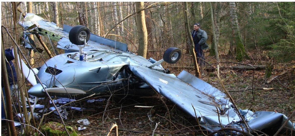
Рис. 2. Состояние центроплана.
