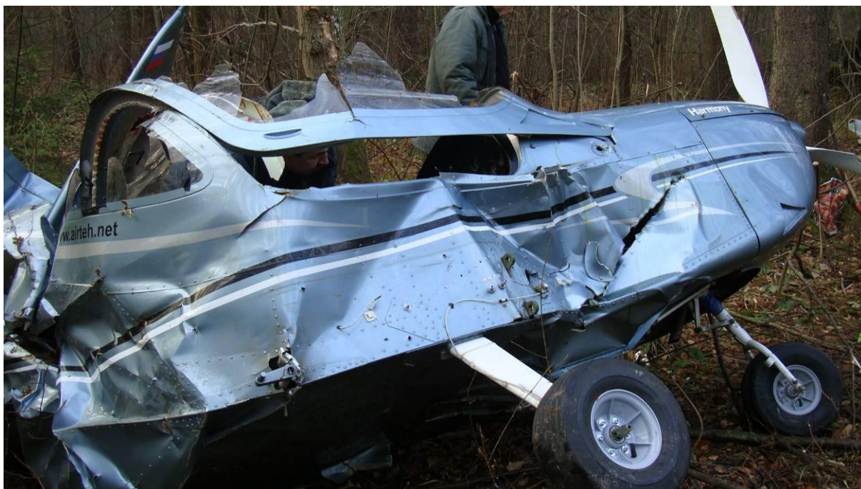
Рис. 3. Состояние центроплана.
