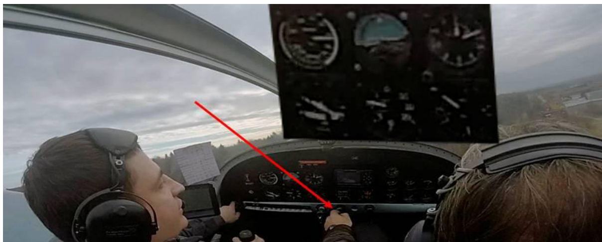
Рис. 35 Начало уборки РУД КВС (указано красной стрелкой).
