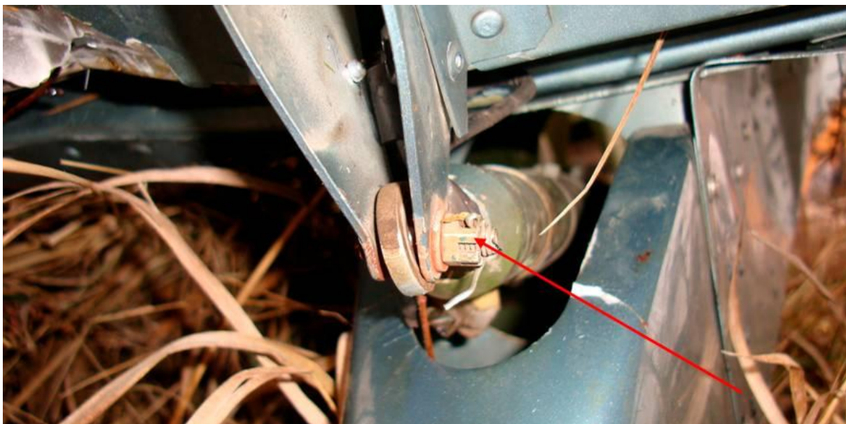
Рис. 11. Место крепления тяги руля высоты (указано стрелкой).
