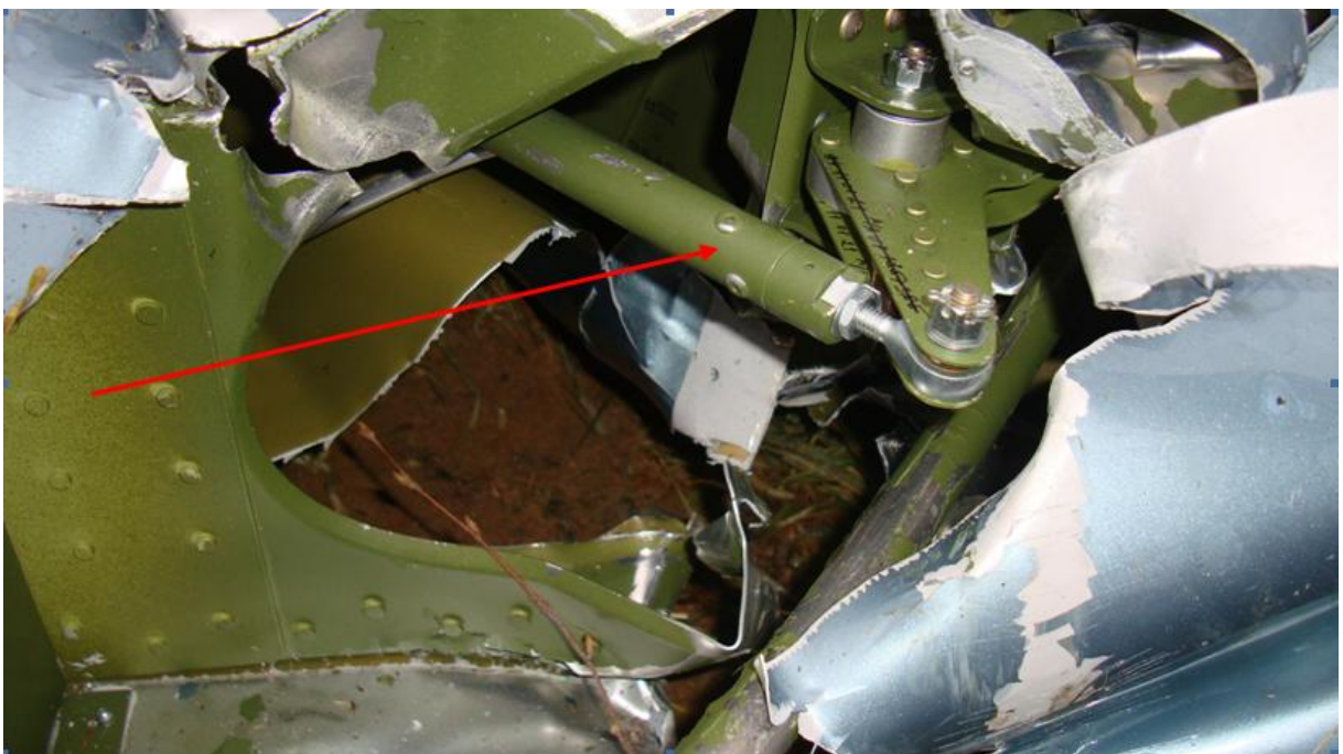
Рис. 9. Тяги руля высоты (указано стрелкой).
