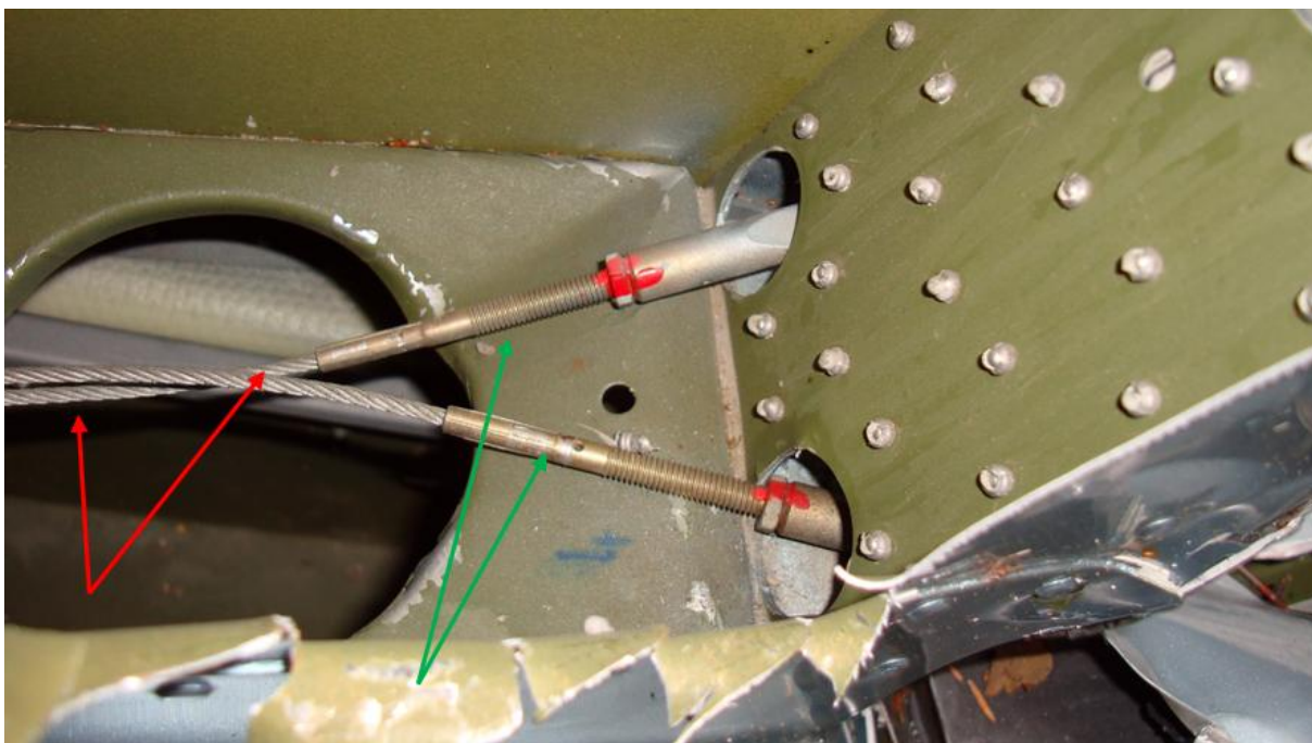
Рис. 10. Тяги и тросовая проводка управления рулем направления (зеленая стрелка – тяги, красная стрелка – троса).
