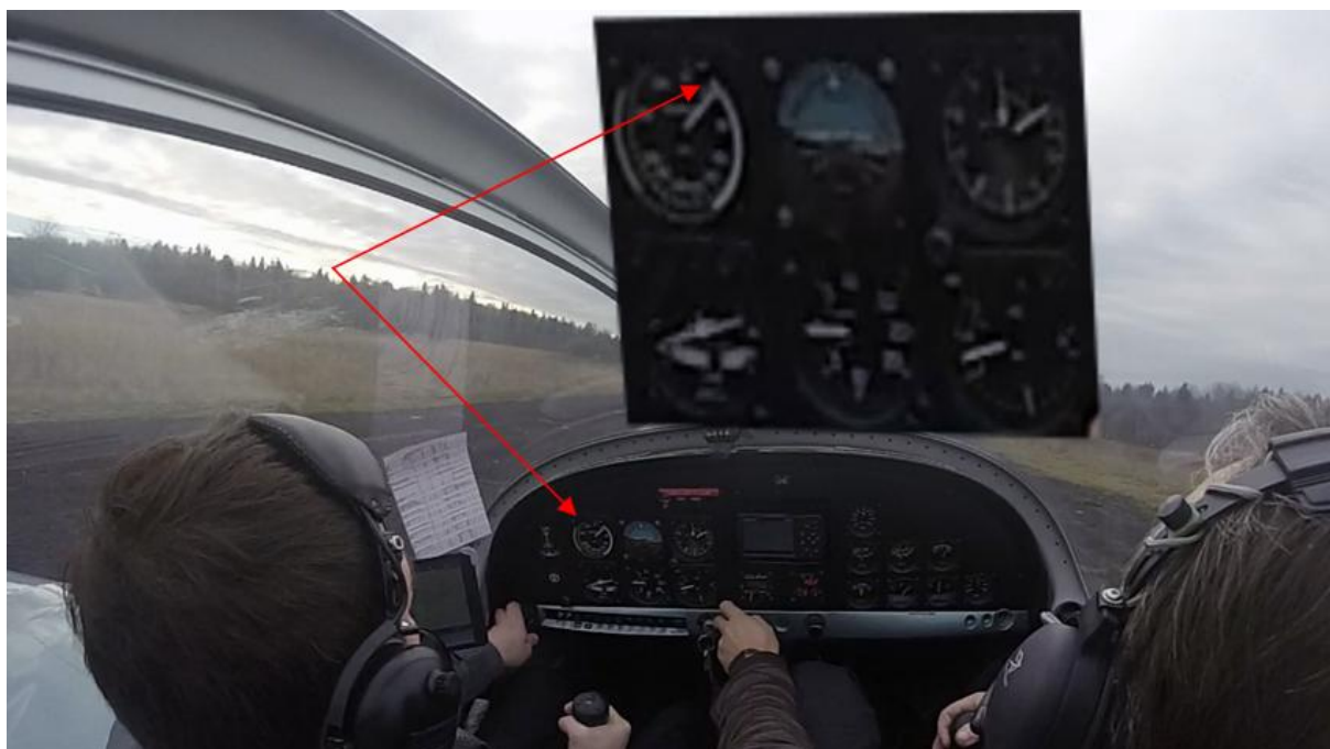
Рис. 32 Величина скорости после перестановки РУД (красная стрелка: скорость по индикатору скорости ~ 60 км/час).
