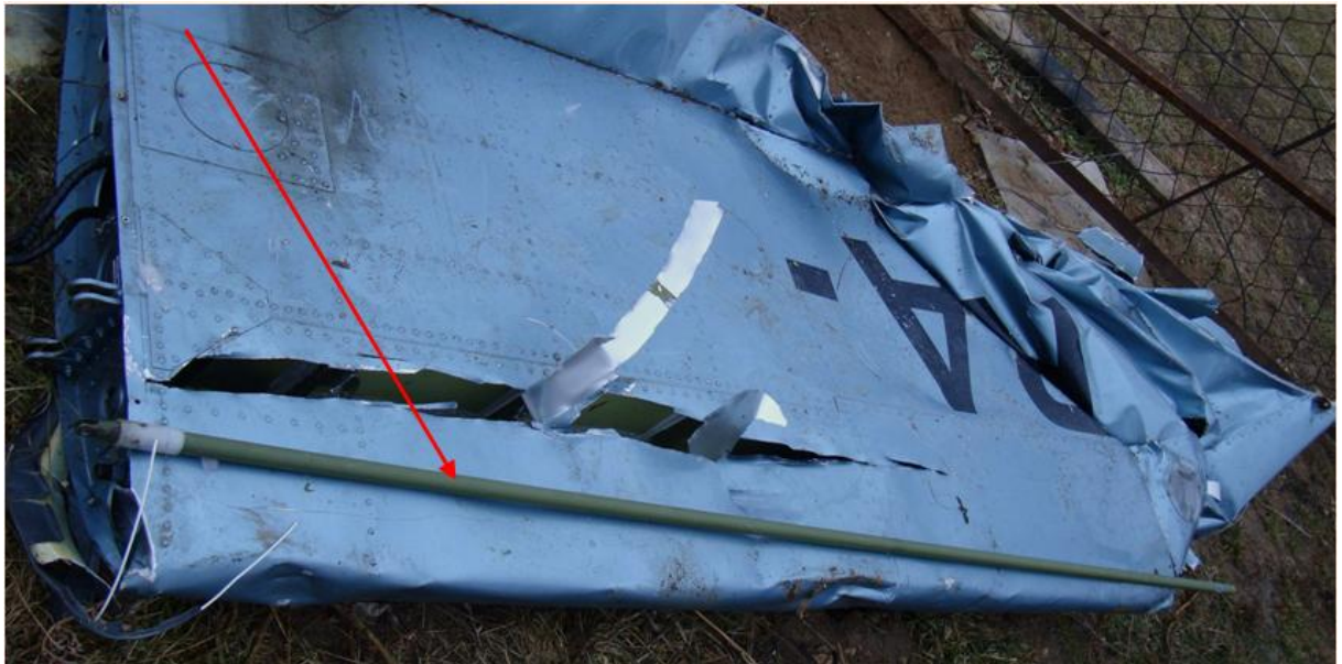
Рис. 8. Тяги управления элеронами (указано стрелкой).
