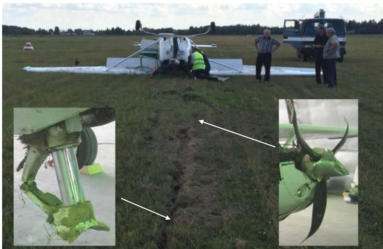
Рис.7 Положение следов от передней стойки и лопастей воздушного винта на месте АП
