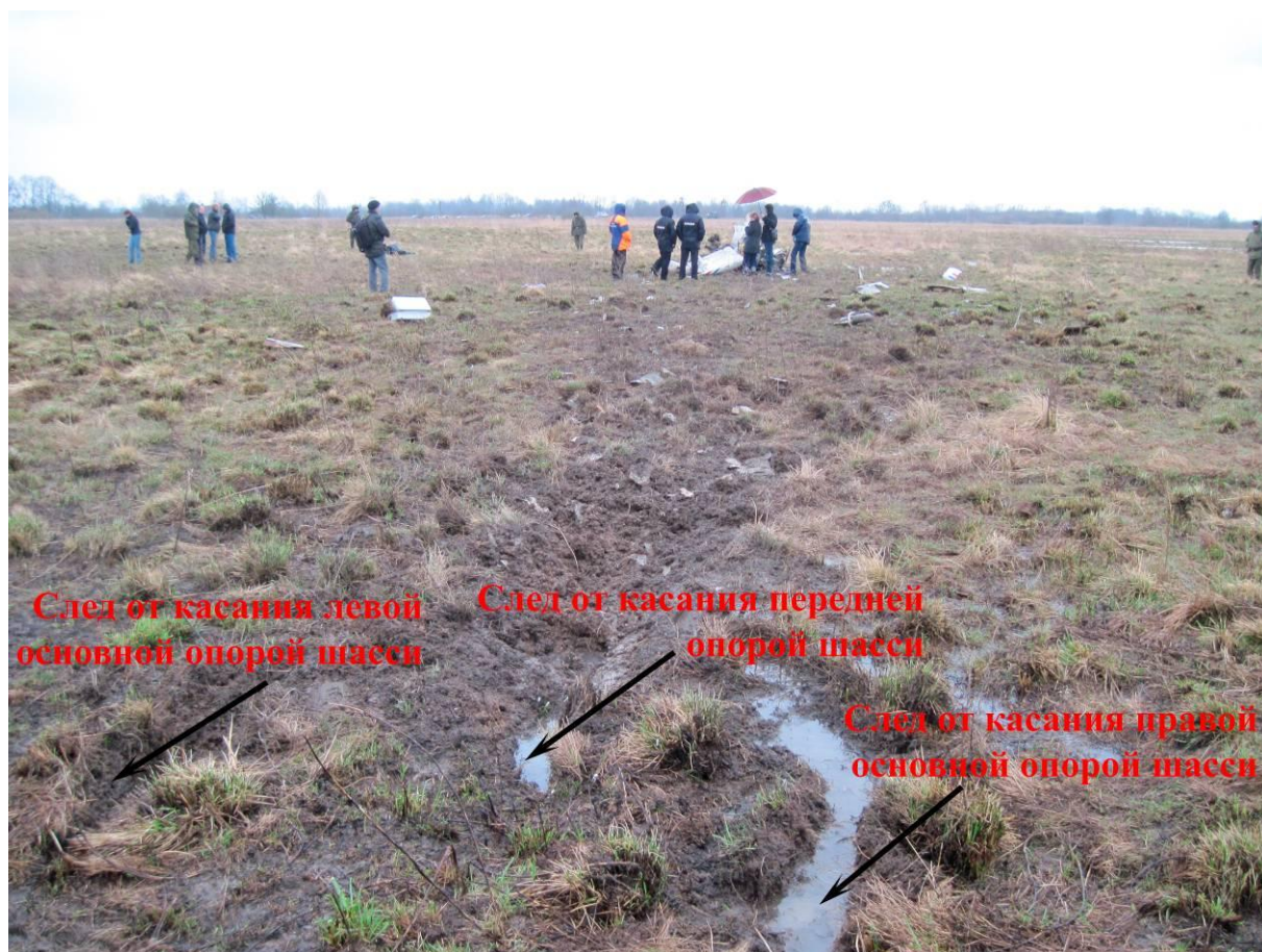
Рис. № 3. Следы первого касания самолетом земли.
