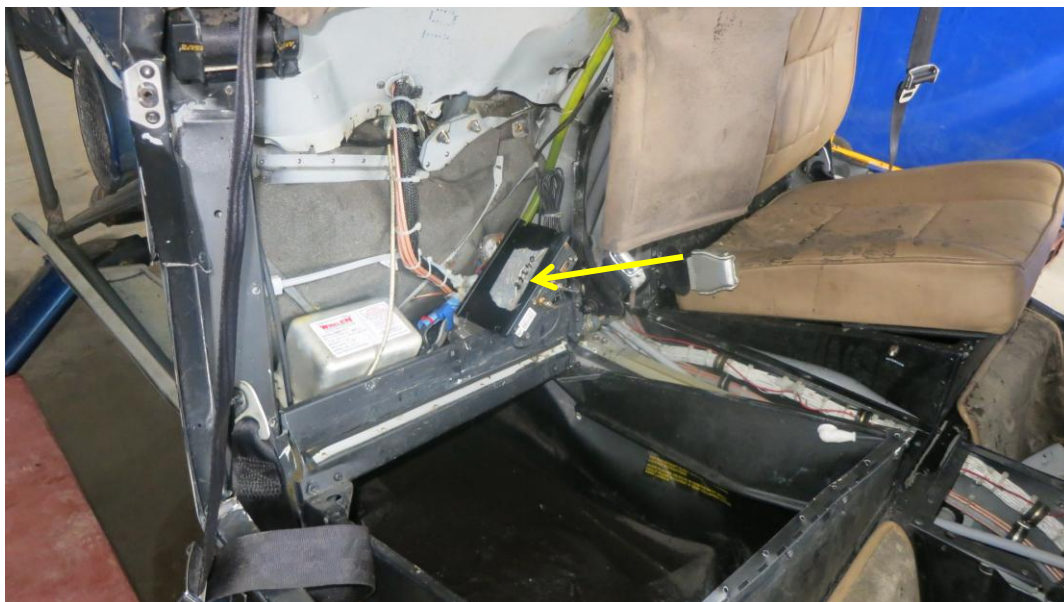
Рис. 14. Место установки (указано стрелкой) мобильного терминала УТП-М-01-8.005.19 в кабине вертолёта
