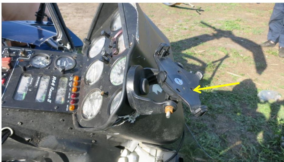
Рис. 13. Место установки (указано стрелкой) GPS навигатора «GARMIN 276C»
