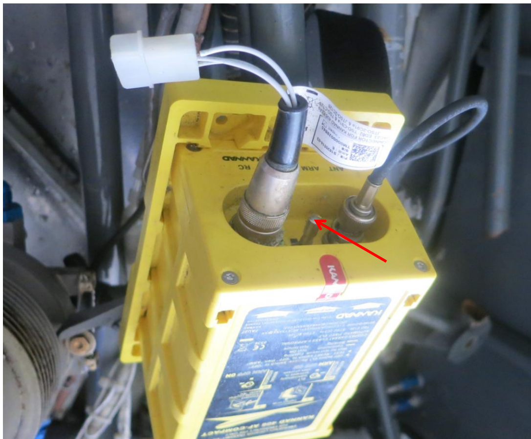
Рис. 10. Внешний вид АРМ модели KANNAD 406 AF COMPACT (стрелкой указан выключатель)
