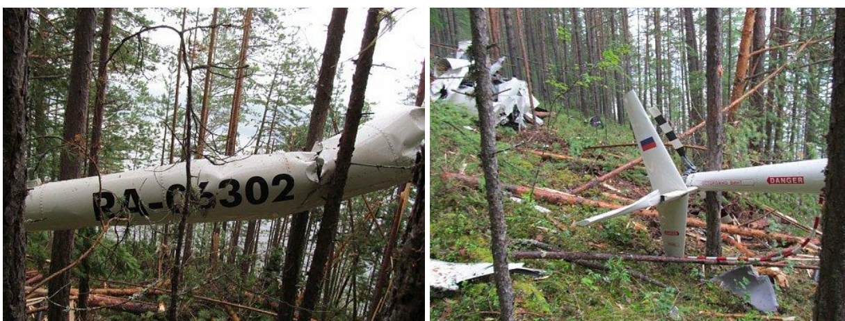
Рис.4 Хвостовая балка вертолѐта R-44 RA-06302 на месте АП
