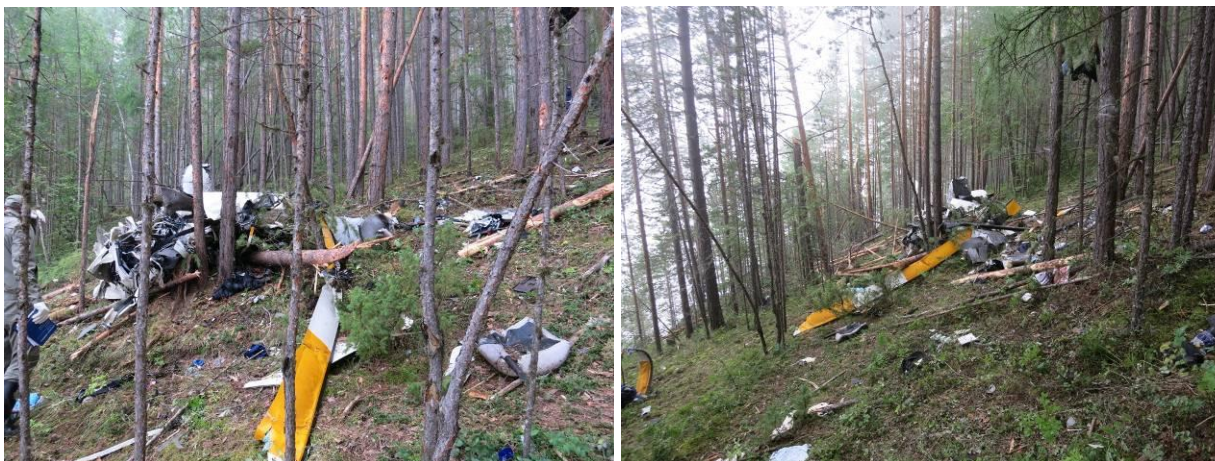
Рис.5 Лопастѝ НВ вертолѐта R-44 RA-06302 на месте АП
