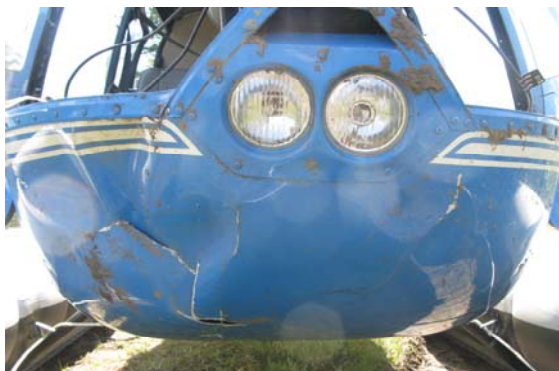
Рис.4. Поврежденная носовая часть фюзеляжа
