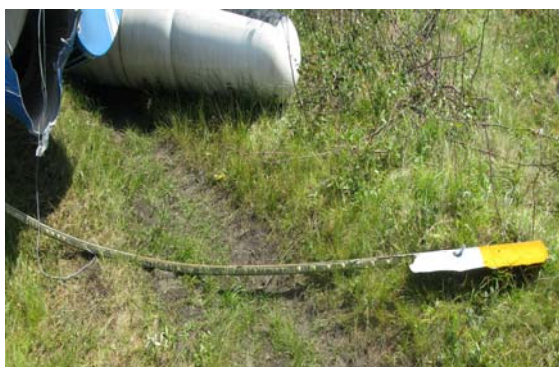
Рис. 6. Разрушенная лопасть несущего винта
