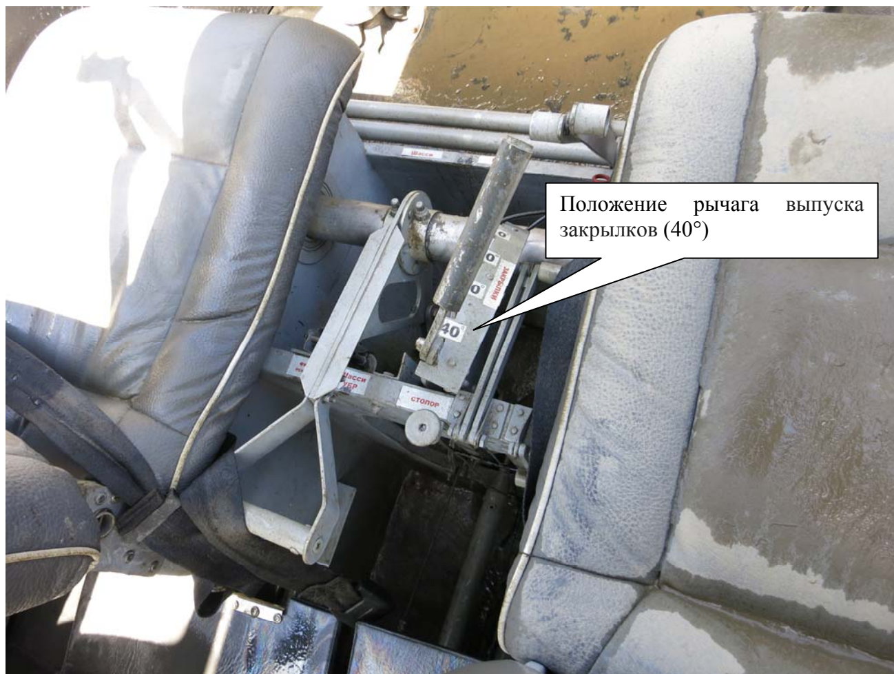
Рис.12. Положение рычага выпуска закрылков в кабине самолета на месте АП
