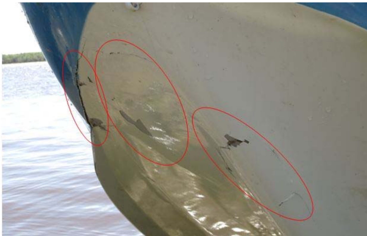
Рис. 4. Повреждения пластикового корпуса ВС с наружной стороны
