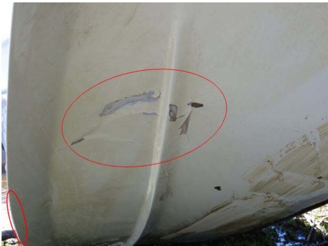
Рис. 3. Повреждения пластикового корпуса ВС с наружной стороны
