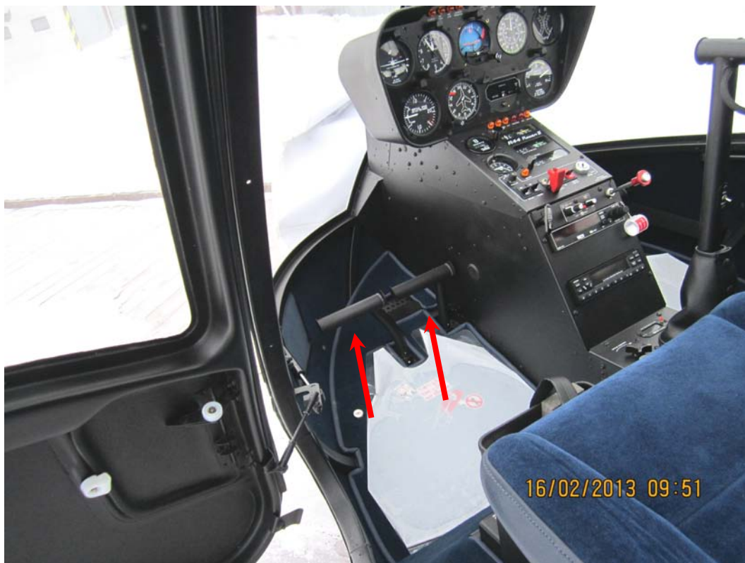
Рис. 12. Переднее левое кресло в кабине вертолета-аналога Robinson R-44 с педалями управления рулевым винтом
