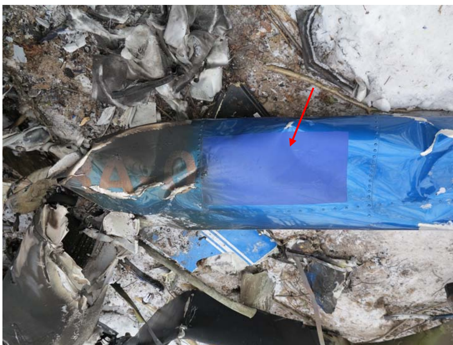
Рис. 3. Хвостовая балка вертолета с заклеенным регистрационным опознавательным знаком
