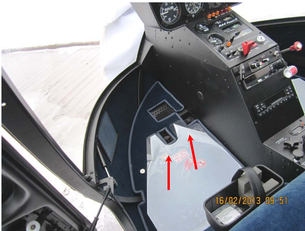
Рис. 13. Переднее левое кресло в кабине вертолета-аналога Robinson R-44 со снятыми педалями управления рулевым винтом
