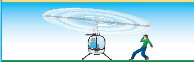
Рисунок 8-3. Безопасные процедуры подхода к вертолету и отхода от него.
