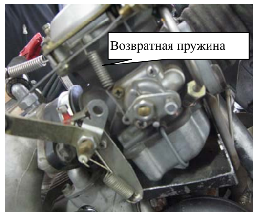
Рис. 11. Промежуточное положение рычага обогатителя карбюратора на самолете Х-32 RA0642G
