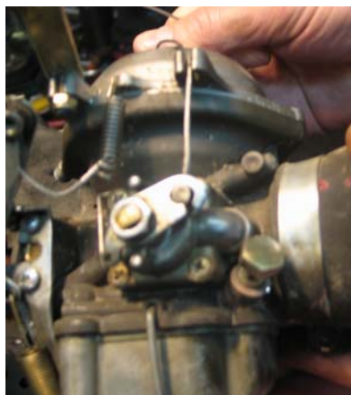
Рис.10. Рычаг обогатителя карбюратора в положении «Выключен».
