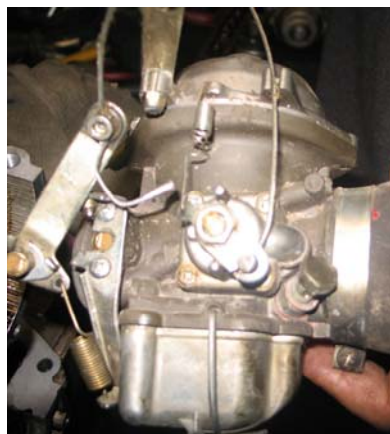
Рис. 9. Рычаг обогатителя карбюратора в положении «Включен».
