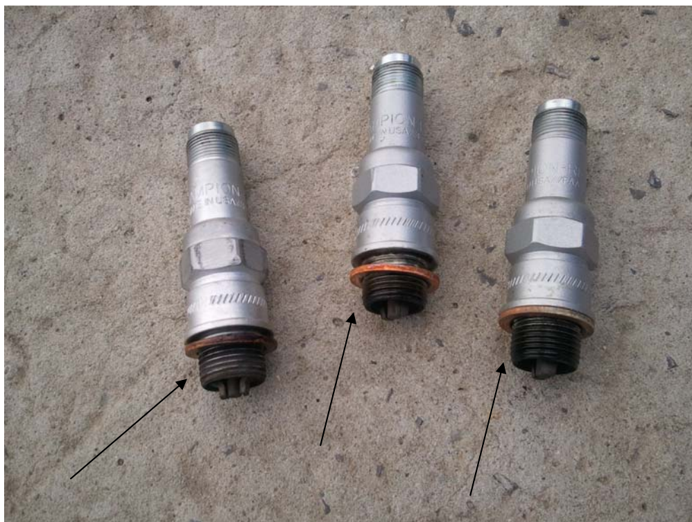
Рис. 5. Стрелками указаны места нагарообразования и масляный налет
