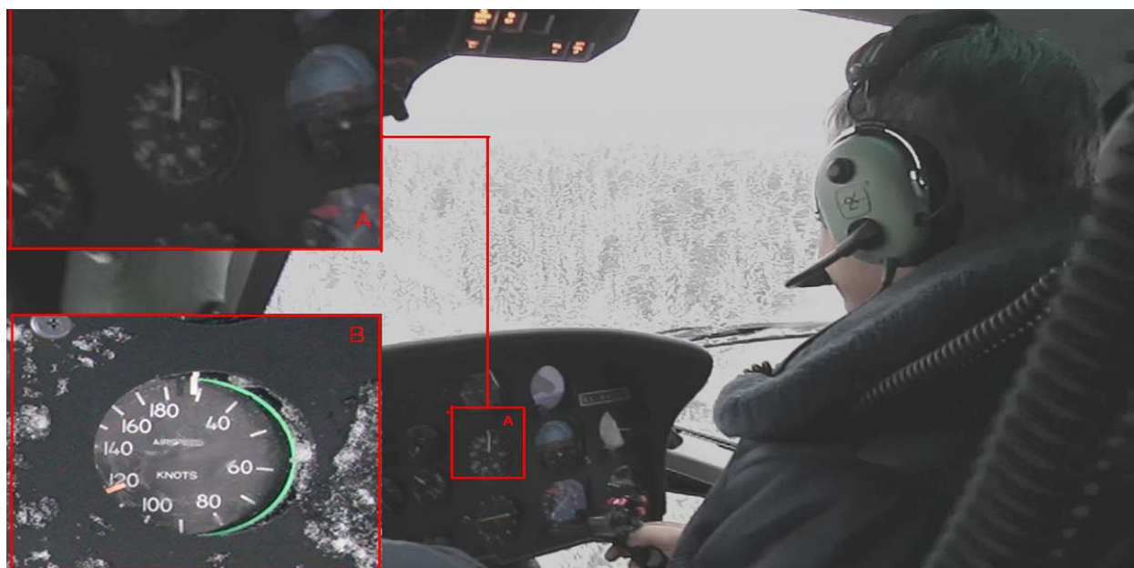
Рис.6. Вертолет взлетел с в.п. Валаам. В квадрате А на указателе скорости V \approx 0 \text{ kts} . В квадрате В показана градуировка шкалы указателя скорости.
