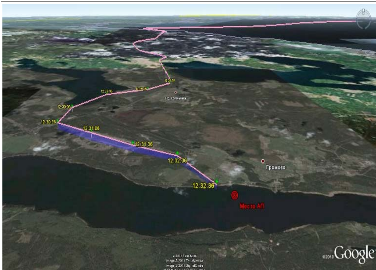
Рис.1. Траектория полета вертолета за 20 января 2011 года, выполненная по результатам расшифровки записей GPS BENDIX/KING SKYMAP IIIС.
