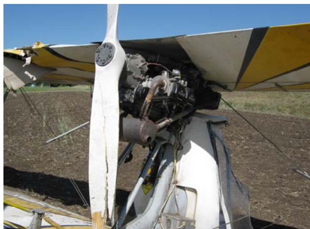
Фото 2. Вид на разрушенную лопасть воздушного винта
