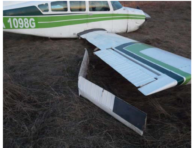
Вид самолета справа с оторванным закрылком
