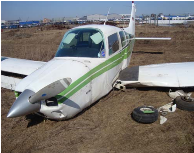
Вид самолета с разрушенными с основными стойками шасси
