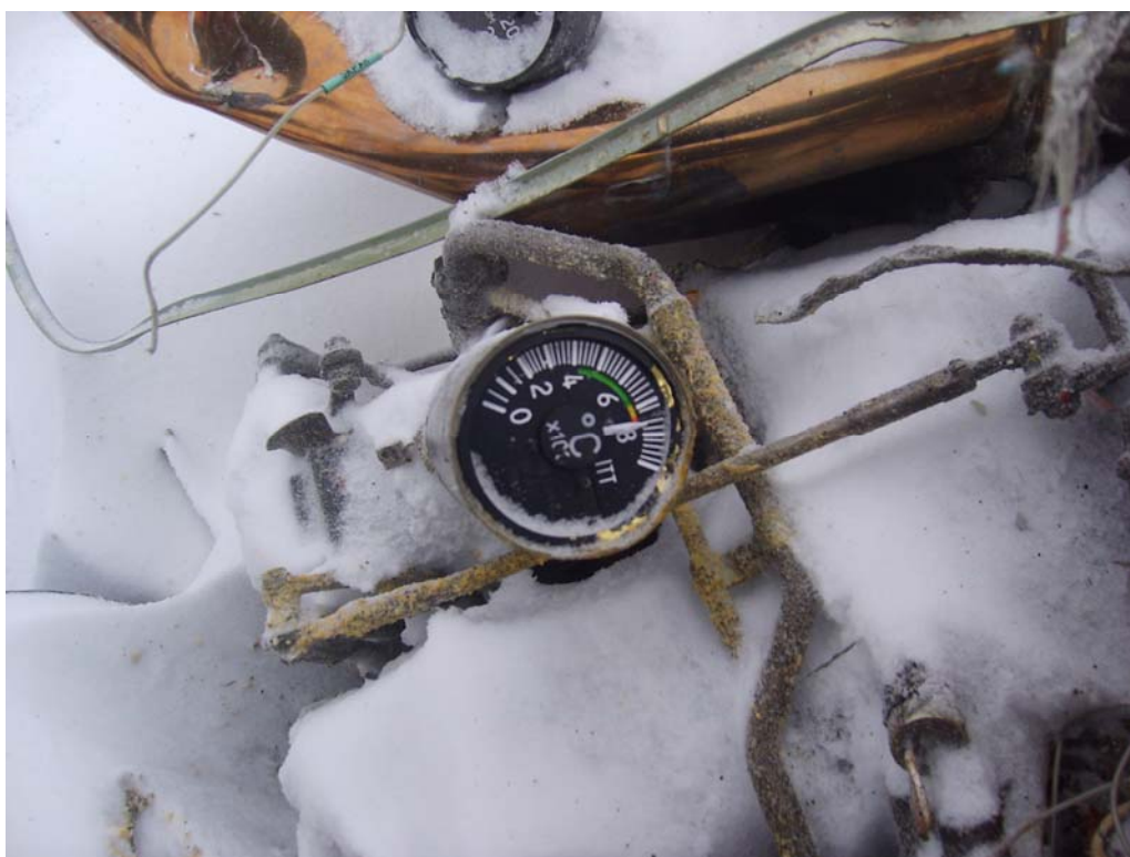
Рис. 15. Индикатор температуры между турбинами ЛУН 1370.02-8
