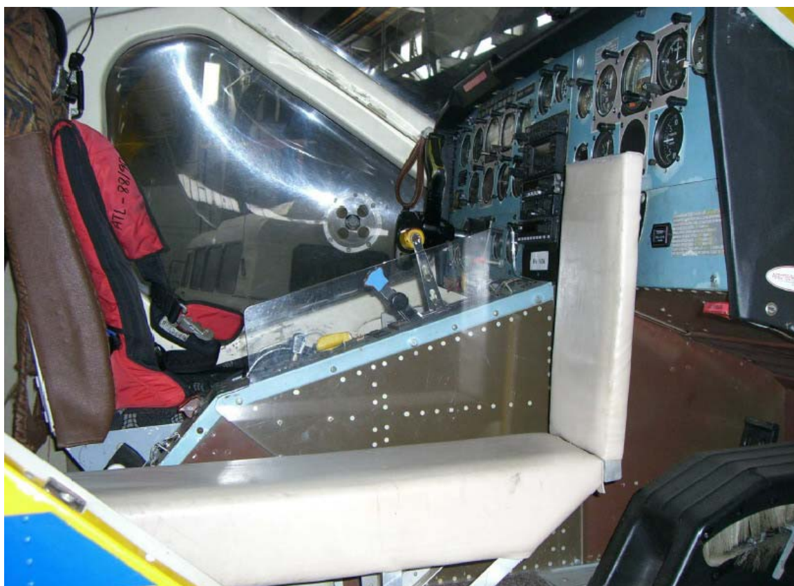
Рис. 9. Защита среднего пульта и демонтированного правого штурвала на самолете SMG-92
