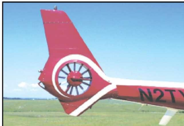
Рисунок 1-4. По сравнению с незащищенным хвостовым винтом фенестрон обеспечивает более высокий уровень безопасности при наземных маневрах.
